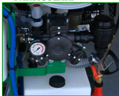
POMPA A 3 MEMBRANE IN VITON E CISTERNA CIRCUITO SECONDARIO
