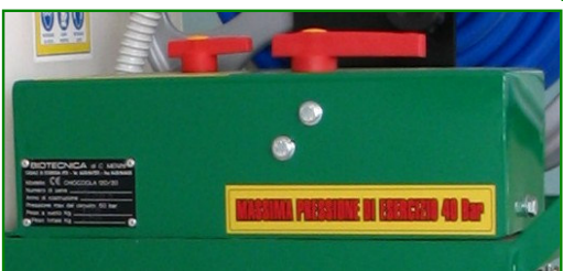
VALVOLE A TRE VIE PER LA SELEZIONE DELLA CISTERNA PRINCIPALE O SECONDARIA O PER IL RISCIAQUO DELL'IMPIANTO
