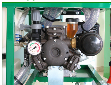
POMPA A 3 MEMBRANE IN VITON E CISTERNA CIRCUITO SECONDARIO
